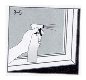
窓ガラスとフィルムの位置合わせが出来ましたら、スプレイに入った溶液をフィルムの表面全体にスプレイします。これは、"T"型ゴムベラを滑り易くする為です。滑り易くすることで、ガラスとフィルムの間に入った気泡と溶液を簡単に押し出すことができます。
