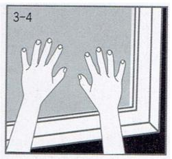
溶液がガラス板とフィルムの間に十分ある状態 ですと、フィルムを手で動かすことができます。 この状態で全体の位置合わせを行ってください。
