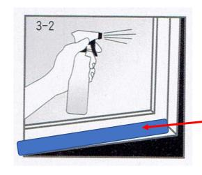
スプレイボトルに入った溶液を窓ガラスに少し 多めに吹き付けます。
