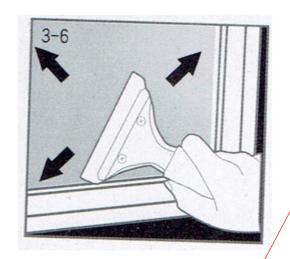
"T"型ゴムベラを用いてのフィルムの貼り付けは、ガラスの真ん中辺りからゴムベラを使って上下左右にフィルムをならす様にしてガラスとフィルムの間の溶液と気泡を押し出します。
